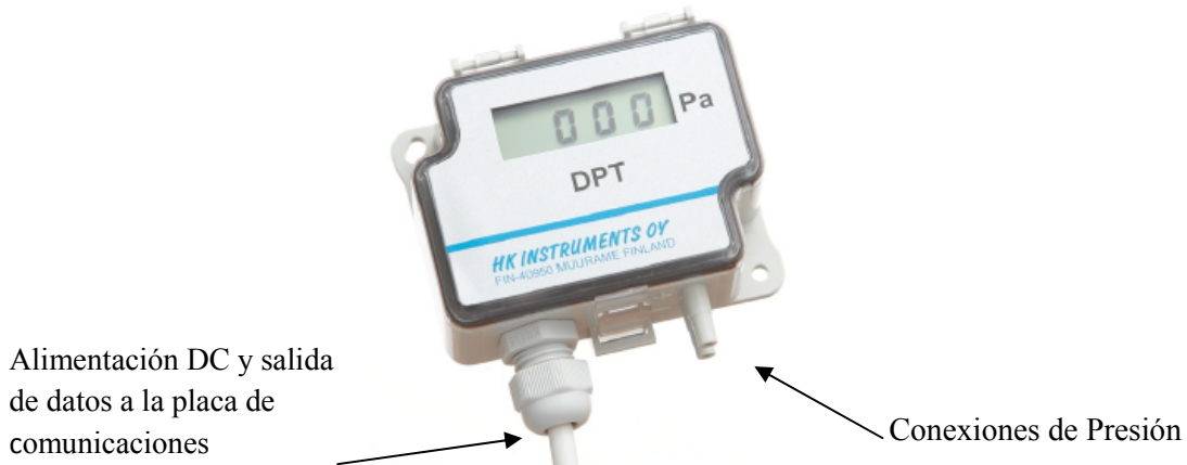
Fig. 5. Manómetro diferencial marca DPT Clase 1 de 50/100 Pa. a fondo de escala mostrando las conexiones eléctricas, de datos y de presión.
